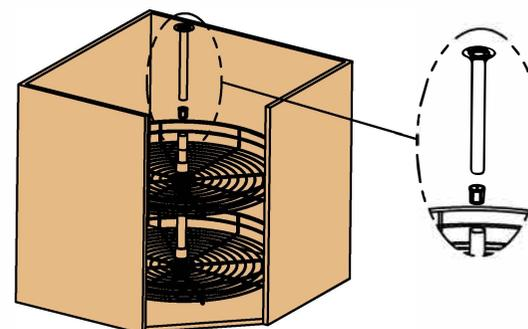
2.2 последовательно вставьте кольцо заглушки и регулировочную трубку в вертикальную трубу.
