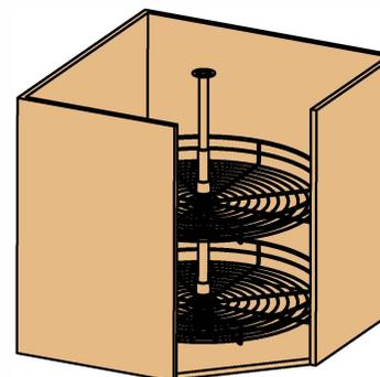
3.1 Закрепите вертикальную трубу и регулировочную трубку саморезами ST15\*16 с полукруглой головкой и зафиксируйте корзины для завершения установки.
